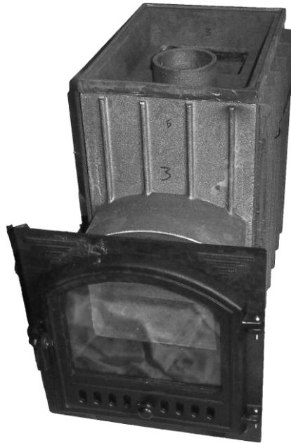
12. На портал печи устанавливается дверка со стеклом.
