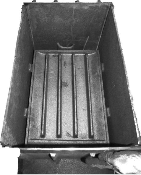
8. На отливы боковых стенок устанавливается нижняя часть каменки (сердце). Закругленные края устанавливаются к задней стенке.
