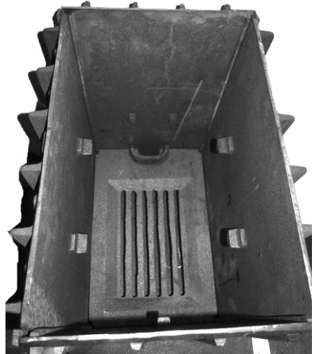
6. На отливы задней и передней стенки устанавливается колосниковая решетка
